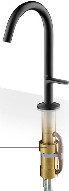
Die außergewöhnlich schlanke Silhouette ist dank der Positionierung der Kartusche unterhalb des Waschtischs möglich. Gleichzeitig bietet sie so die Möglichkeit einer schnellen und einfachen Installation sowie leichten Service- und Wartungszugang: Es muss nur das Wasserrohr entfernt werden während die Kartusche einfach per Bayonettverschluss entfernt wird.
